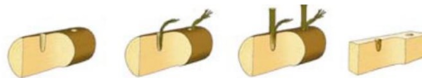
Afb.3.67 Wijze waarop wilgentenen en spie in het hout werden aangebracht Afbeelding Dik de Roon/BMA Amsterdam
