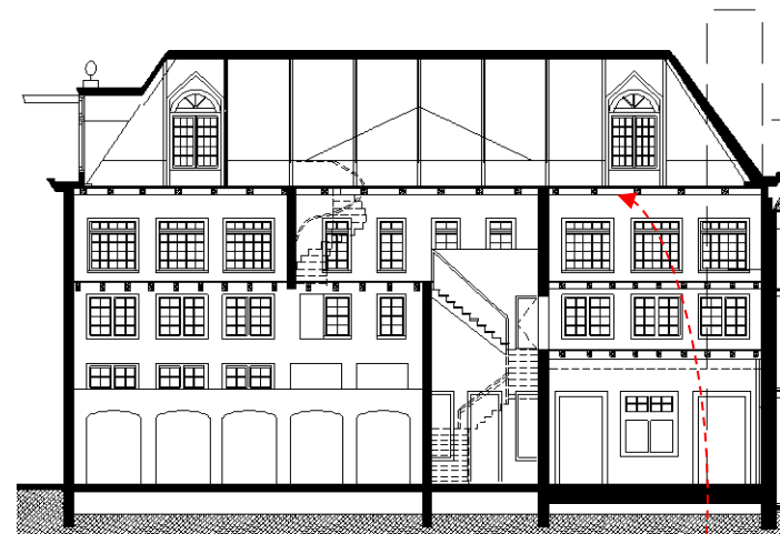
Afb.2.01 Langsdoorsnede met vloerbalken
